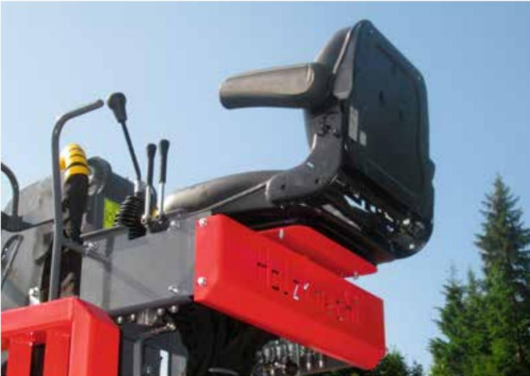
● Hochsitz mit Fußpedalbedienung, Kreuzhebel oder Joystick
