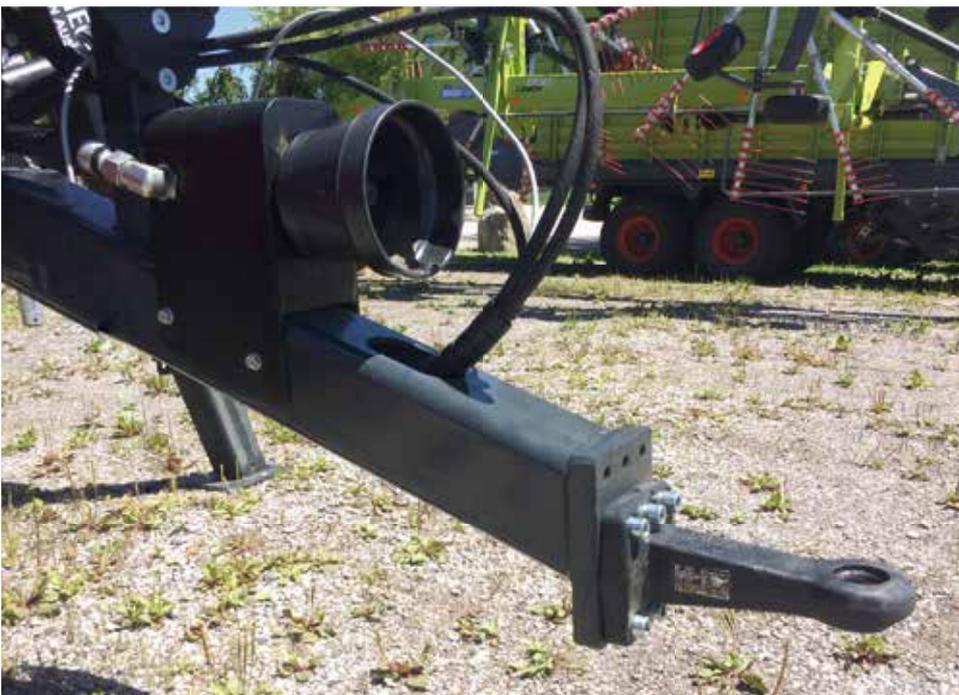
● Gekröpfte Deichsel nach unten mit Pumpe u. Tank fix aufgebaut
