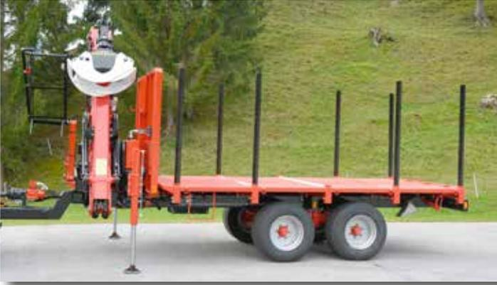
● Plateau 4 x 2,2 m mit geraden Rungen, verschiedene Rungenhöhen möglich, Rungenhalter hinten
