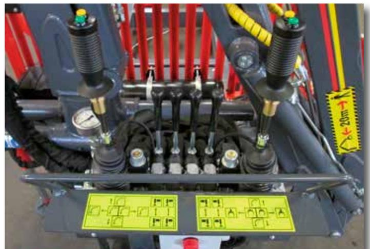
● Steuerblock, geeignet für Zusatzfunktionen z.B. hydraulischer Seitenverschub
