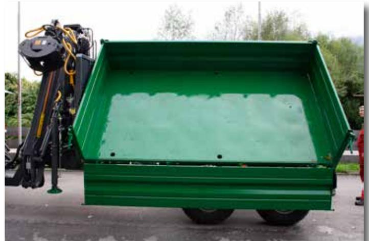
● 3 Seitenkipperaufbauten (versch. Höhen mögl.)
